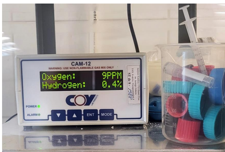
Rys. 3. Czujnik wodoru w komorze rękawicowej. Warto pamiętać, aby raz na jakiś czas go skalibrować.
