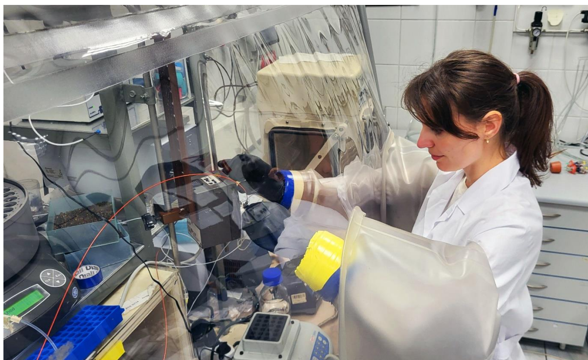
Rys. 2. Praca z enzymami beztlenowymi wymaga specjalnej komory rękawicowej, wypełnionej atmosferą pozbawioną tlenu. W naszym urządzeniu jest to azot z niewielką domieszką wodoru.
