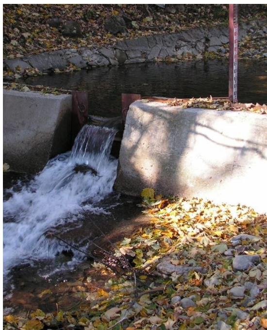
Rysunek 2. Przekrój pomiarowy na potoku Czarna Woda oraz limnigraf (fot. A. Jaguś)
