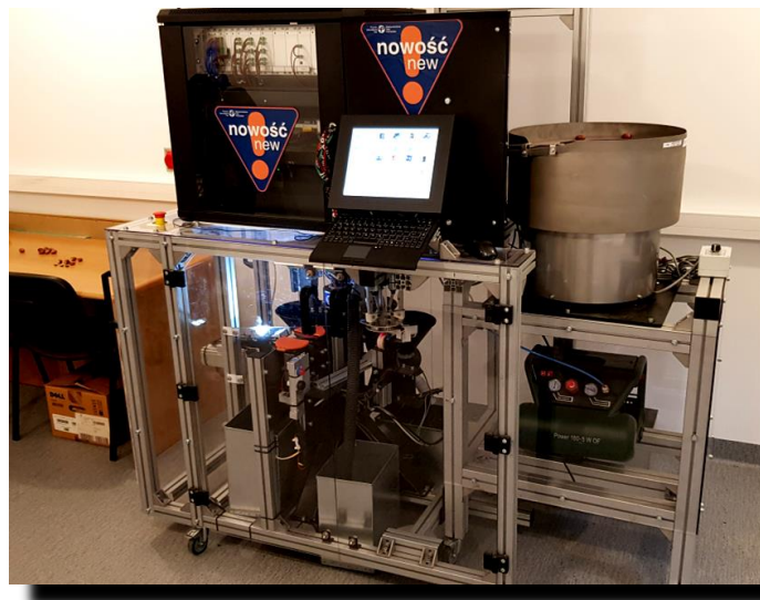
Ryc. 1. Robot do przedsięwzięcia skaryfikacji i sortowania żołądki
