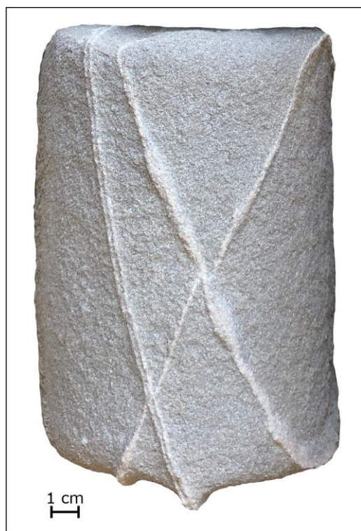
Fig. 1. Wstęgi deformacyjne w utworach czerwonego spągowca (fragment rdzenia wiertniczego z otworu W-20)
